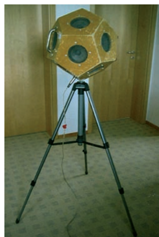
Abb. 19 - Kugellautsprecher, wie er bei der Bestimmung der Luftschalldämmung verwendet wird [7.14]
